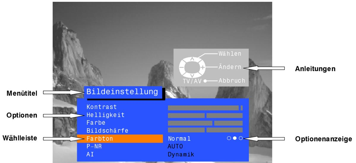
Bei einigen Funktionen - z.B. **Kontrast**, **Helligkeit**, **Farbe** und **Bildschärfe** - kann der Pegel eingestellt werden.
